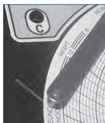
Nadel des Aufzeichnungsgeräts und Zeitleistennut
